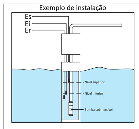
**Ajuste da Sensibilidade:** Conforme o líquido utilizado e a distância entre os eletrodos, haverá diferentes condutibilidades. Por isso, existe no frontal do relé um ajuste de sensibilidade, permitindo seu uso com diversos líquidos condutores e não inflamáveis.
