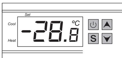
Instruções de exibição: LED de três dígitos + dígito negativo + luz indicadora de status (Frio, Calor) + Luz indicadora de configuração
